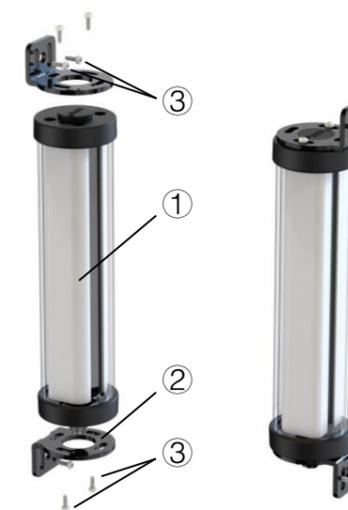
图 7-1 上下安装支架安装示意图
